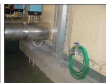
④ 貯水槽本体に直接蛇口を付け給水
