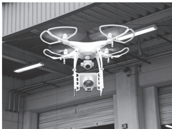
ドローンに搭載したレーザーファルコン 上空100mから地上のガス漏洩を探索可能
