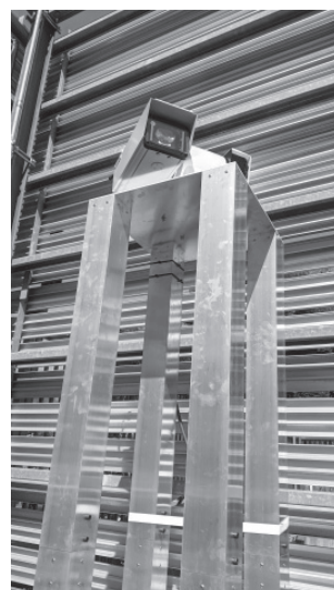
レーザーファルコンを 応用した定置型の ガス漏洩監視システム
