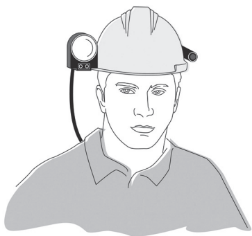
ヘルメットに取り付けたレーザーメタンのイメージ図 ハンズフリーで作業を行いながら漏洩検知を行うことができる
