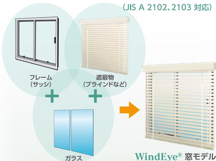
WindEye® で窓全体 (フレーム+ガラス+遮蔽物) の熱貫流率 (U値)、日射熱取得率 ( $\eta$ 値) を任意の窓サイズで計算可能
